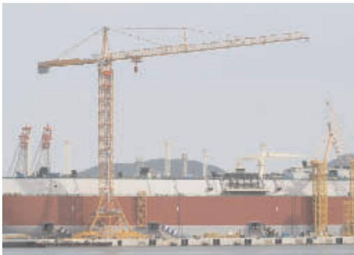
Im Februar entstand im Werk Biberach der größte Kran, den Liebherr je baute. 970 Tonnen schwer, 96 Meter hoch und mit einer Auslegerreichweite von 96 Metern. Er wurde an eine Werft in Südkorea geliefert.
